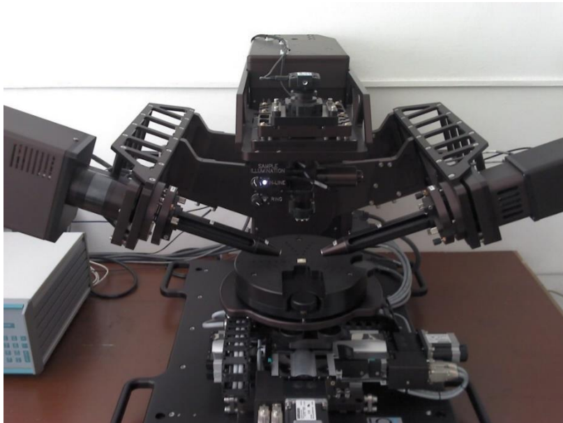
Фиг. 7 M-2000® Spectroscopic Ellipsometer (J.L. Woollam Co. Inc., USA)
