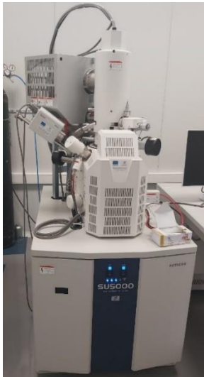
Фиг. 13 Сканиращ електронен микроскоп SU5000 (HITACHI, Germany) и принцип на работа на SEM (Wikimedia Commons)
