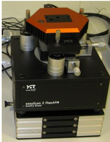
Фиг. 15 Атомно-силов микроскоп Easyscan 2 (Nanosurf, Switzerland)
