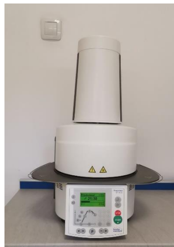
Фиг. 3 Апарат за пресоване на стъклокерамика (Programat EP 3000, Ivoclar Vivadent, Shaan, Liechtenstein)
