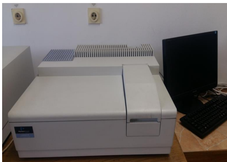
Фиг. 6 Стандартен спектрофотометър Perkin Elmer model Lambda25 (Perkin Elmer, Orwalk, USA)
